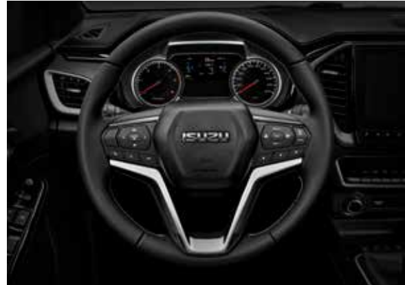
Servodirección Eléctrica. La asistencia a la dirección es mejor en todas las condiciones de conducción: a baja velocidad (dirección más ligera) y a alta velocidad (dirección más dura) lo que aumenta la comodidad y la seguridad de conducción.
